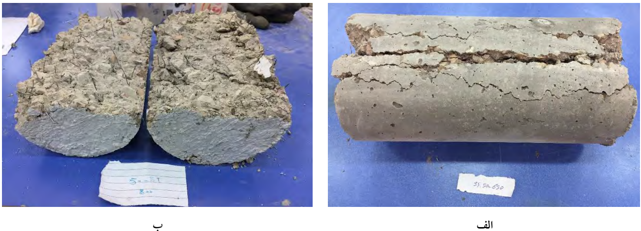
شکل ۸: تصویر نمونه St50 پس از شکست کششی الف) دمای ۶۵۰ درجه سانتیگراد، ب) دمای ۸۰۰ درجه سانتیگراد.
