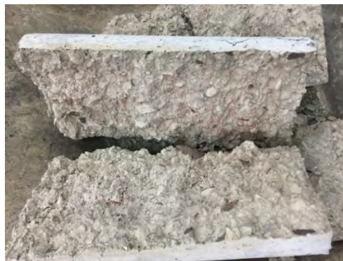
شکل ۷: شکسته شدن نمونه استوانه‌ای بتن بدون الیاف با هسته گداخته بلافاصله پس از آزمایش.
