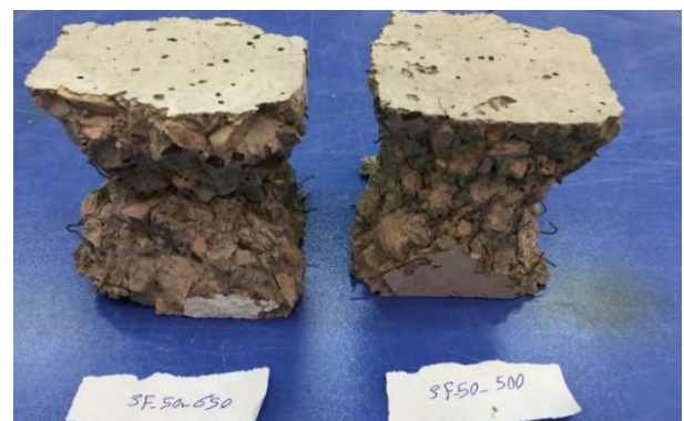
شکل ۶: مود شکست فشاری نمونه St50 در دماهای ۶۵۰ و ۵۰۰ درجه سانتیگراد.
