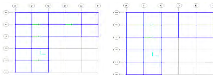
شکل ۶. میراگر در دو نقطه از مدل نامنظم L شکل (سمت راست) و چهار نقطه از مدل نامنظم L شکل (سمت چپ)
