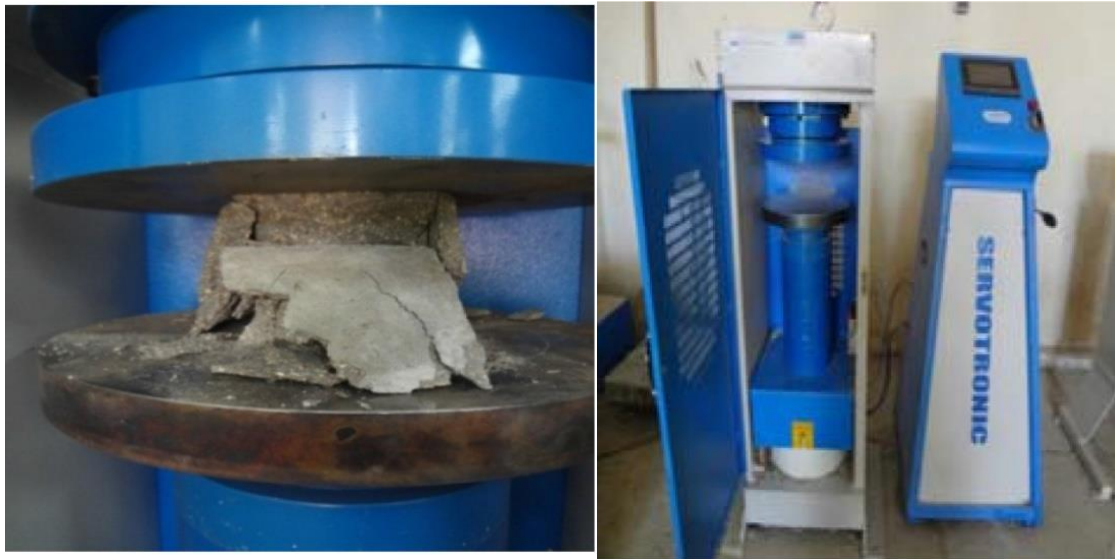
شکل ۳. دستگاه جک بتن شکن به همراه نمونه فشاری بعد از آزمایش
