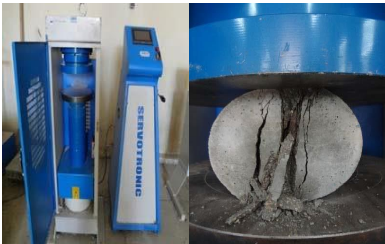
شکل ۴. نحوه انجام آزمایش تست کششی
