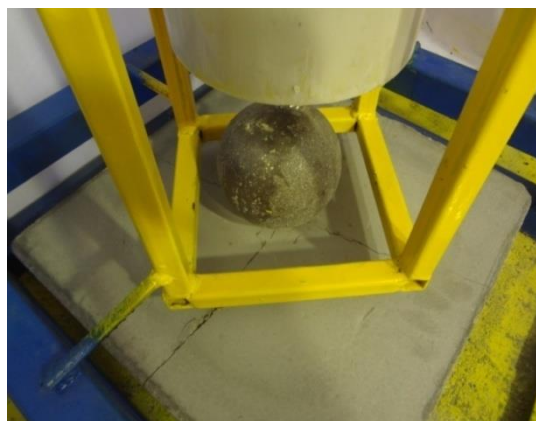
شکل ۱۱: انجام آزمایش ضربه برای تعیین مقاومت اولین ترک دال
