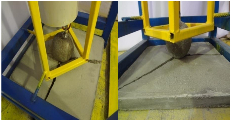
شکل ۱۴: انجام آزمایش ضربه برای تعیین مقاومت نهایی دال
