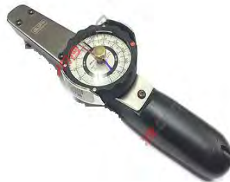
ب- پیچش سنج دستی شکل ۱: آزمون "پیچش".
