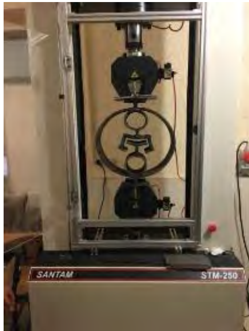
شکل ۲۴: تغییر شکل نهایی دستگیره‌ی انتقال نیرو در نمونه‌ی شماره‌ی یک
