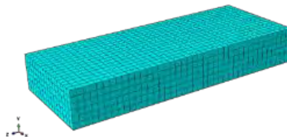
شکل ۱۲: مش بندی یک نمونه دال با استفاده از شکل المان Hex و تکنیک Structured
