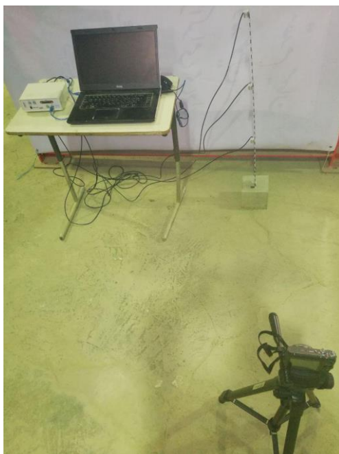
شکل ۳: مجموعه انجام آزمایش شامل دوربین، سازه و حسگرهای شتاب.
