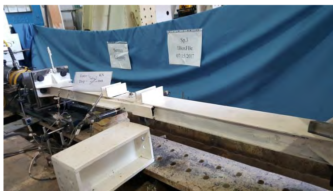
آ. جلوگیری از کمانش موضعی فیوز بوسیله المان‌های کمکی
