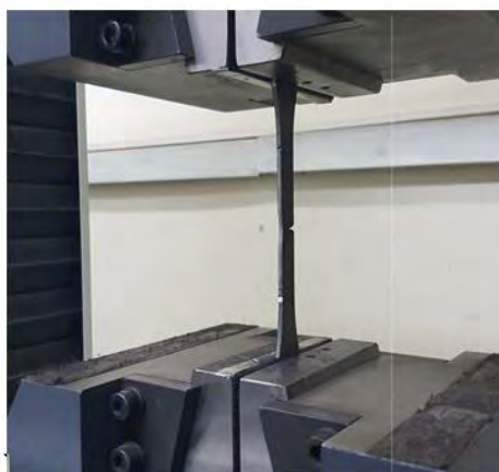
شکل ۹: آزمون تست کشش استاندارد مصالح فولادی
