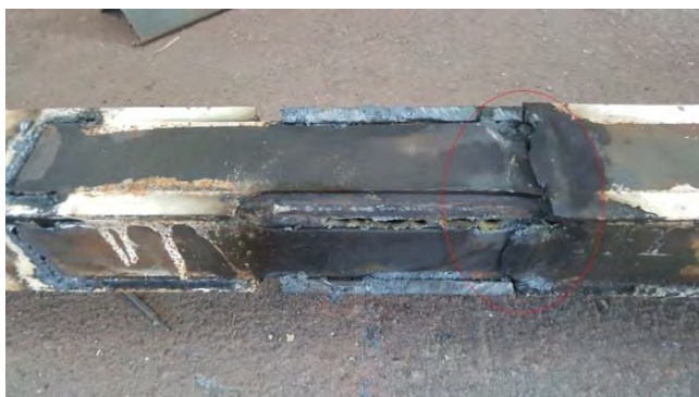
ب. پارگی مهاربند در انتهای فیوز
