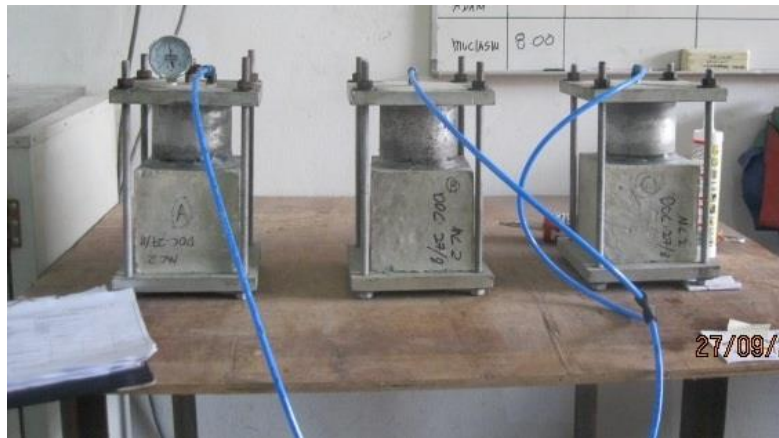
شکل ۷: آزمایش نفوذپذیری آب در بتن.
