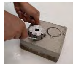
الف) تثبیت دستگاه "انتقال اصطکاک" بر روی مغزه جزئی
