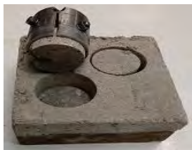
ج) جدا شدن لایه تعمیراتی از بستر
