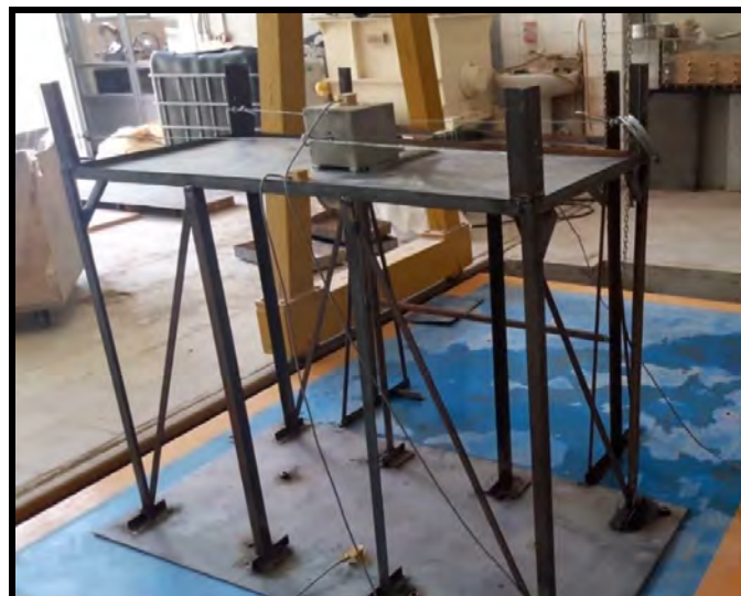
شکل ۳: سیستم مورد آزمایش در محل آزمایشگاه میز لرزه دانشکده عمران دانشگاه تبریز
