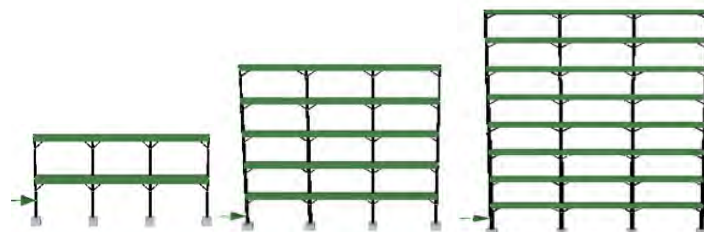
شکل ۲۱: برخورد ضربه‌ی ناشی از وسیله‌ی نقلیه‌ی سبک به ستون گوشه‌ی قاب
