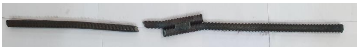
شکل ۸: نمونه میلگرد ۱۴ با وصله پوششی با جوش منقطع کناری در حالت a=2d بعد از انجام آزمایش کشش
