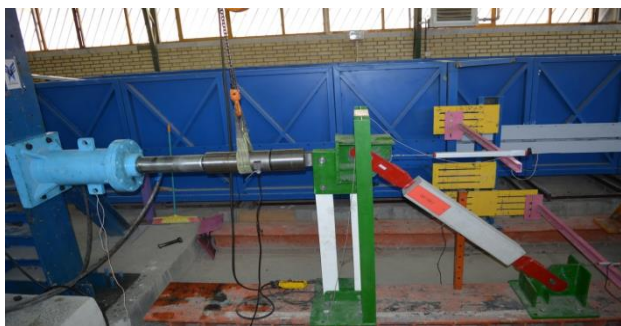
شکل ۵: نمای از قاب ساخته شده با بادبندهای کمانش ناپذیر.
