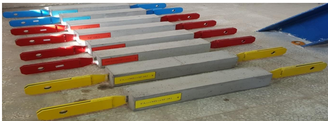
شکل ۹: نمایی از بادبندهای کمانش ناپذیر استفاده شده در این مقاله.
