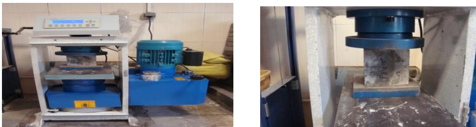
شکل ۷: دستگاه اندازه گیری مقاومت فشاری و نحوه شکستن نمونه ها.
