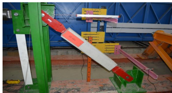
شکل ۵: نمای از قاب ساخته شده با بادبندهای کمانش ناپذیر.
