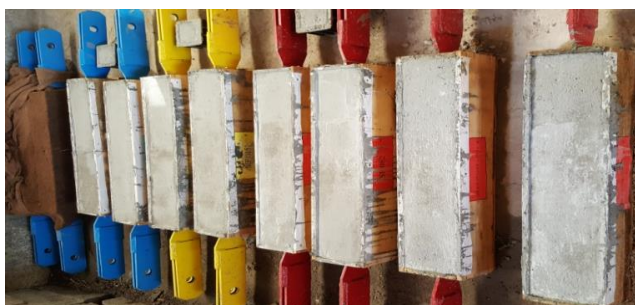
شکل ۶: تصاویری از ساخت و عمل آوری نمونه ها.
