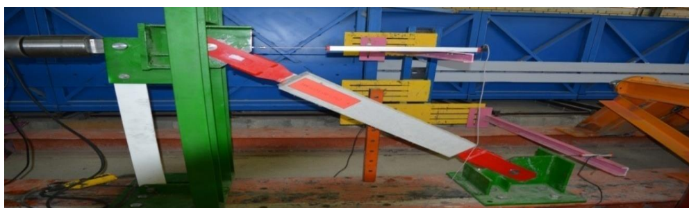
شکل ۱۰: نمایی از بادبند کمانش ناپذیر و LVDT های نصب شده.
