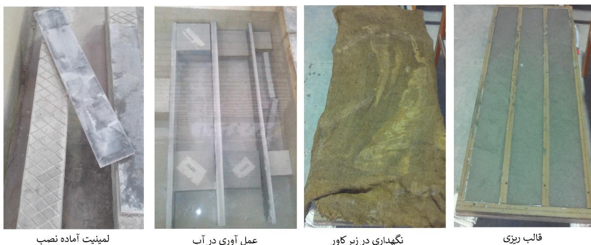
شکل ۷: ساخت و عمل آوری لمینیت ها
