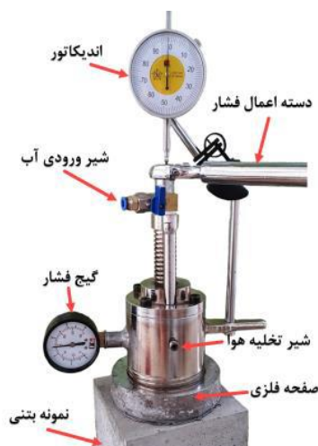
شکل ۱: اجزای مختلف دستگاه "محفظه استوانه‌ای".
