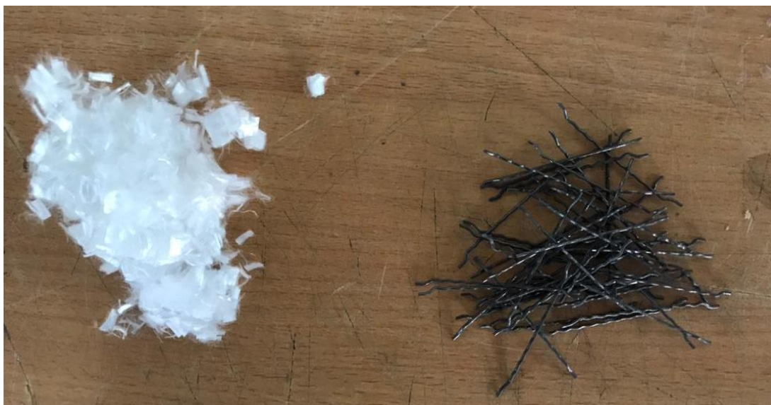
شکل ۲: الیاف‌های فولاد و پلی پروپیلن به کار گرفته شده در این تولید بتن ژئوپلیمر
