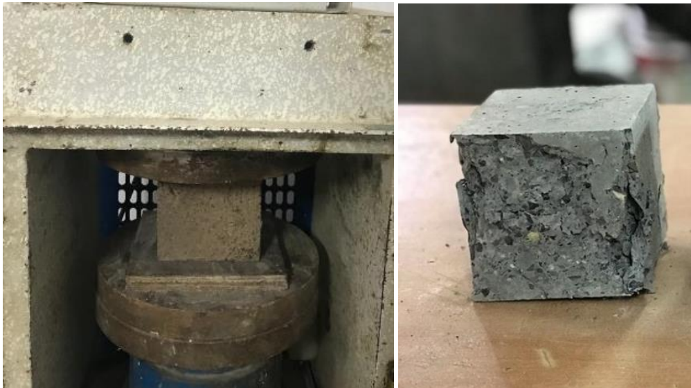
شکل ۸: تصویر شکست نمونه بتن ژئوپلیمری در سن ۷ روزه بعد از آزمایش مقاومت فشاری
