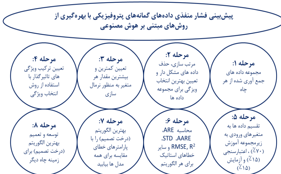
شکل ۱: نمودار گردش کار برای پیش‌بینی نرخ فشار منفذی.
