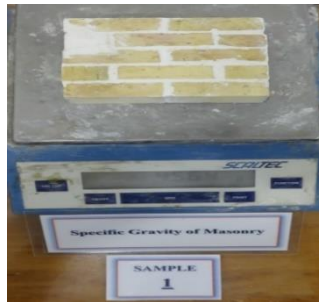
شکل ۱: آزمایش وزن مخصوص ترکیب آجر و گچ
