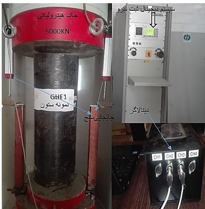
شکل ۷- نحوه بارگذاری و شکست نمونه‌ها توسط جک هیدرولیکی ۵۰۰۰kN
