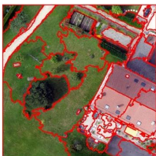
قطعه‌بندی به روش FNEA انتخاب پارامتر مقیاس توسط اپراتور برابر با ۵۵۰
