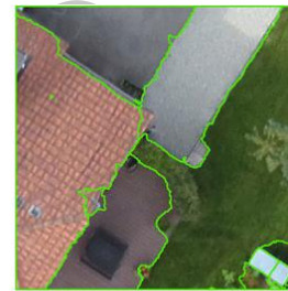
قطعات تصویری تولید شده با استفاده از سوپرپیکسل‌های چهار ضلعی و الگوریتم DBSCAN
