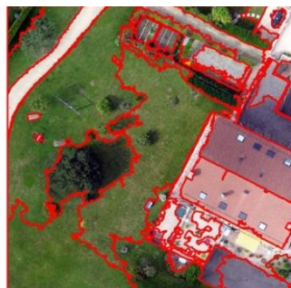
قطعه‌بندی به روش FNEA انتخاب پارامتر مقیاس به صورت خودکار برابر با ۷۳۲
