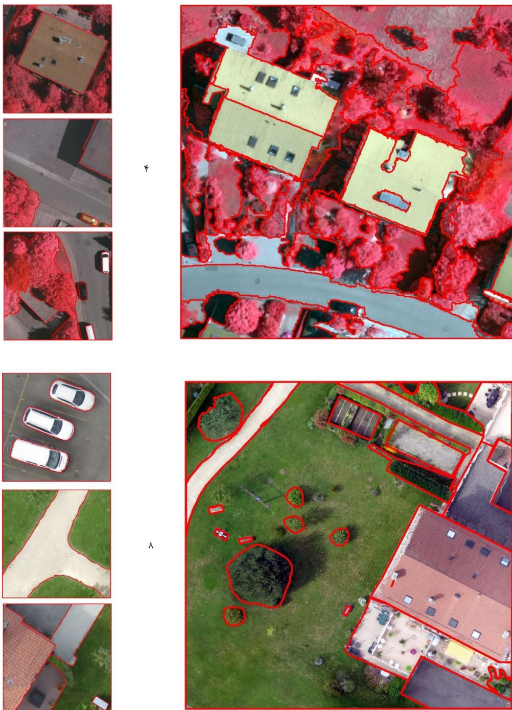
شکل ۳: تصویر رنگی کاذب بخش‌های انتخابی از تصویر هوایی و بهینگن (۴-۱) و تصویر با رنگ طبیعی پهباد از کشور سوئیس (۸-۵) به همراه مرزهای قطعات مرجع
