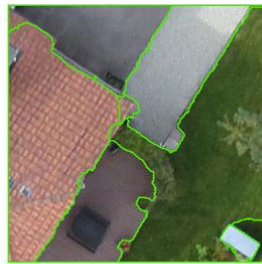
قطعات تصویری تولید شده با استفاده از سوپرپیکسل‌های شش ضلعی و الگوریتم DBSCAN
