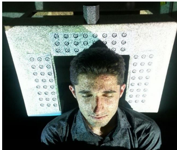
شکل ۷: مکان تعبیه‌شده برای نشستن فرد به همراه الگوی تابیده‌شده روی چهره
