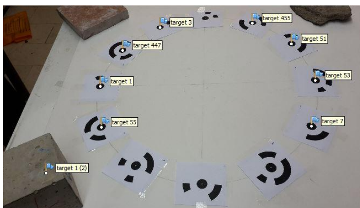
شکل ۱۰: بازشناسی خودکار تارگت‌های کددار تحت عکسبرداری با زاویه ۴۵ درجه در محیط آزمایشگاه
