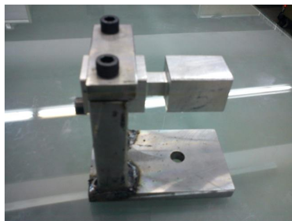
شکل (۷) مکانیزم در نظر گرفته شده برای آزمایش لولای الاستیک.
