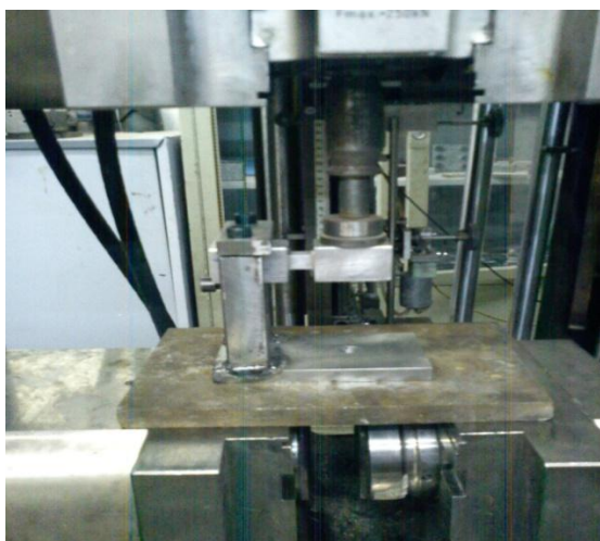
شکل (۷) مکانیزم در نظر گرفته شده برای آزمایش لولای الاستیک.
