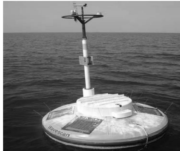
شکل (۱) بویه موج نگار Wavescan عسلویه.
