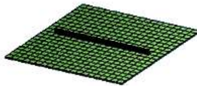
شکل (۸) ورق تقویت شده مدل سازی شده با استفاده از المان Shell63.
