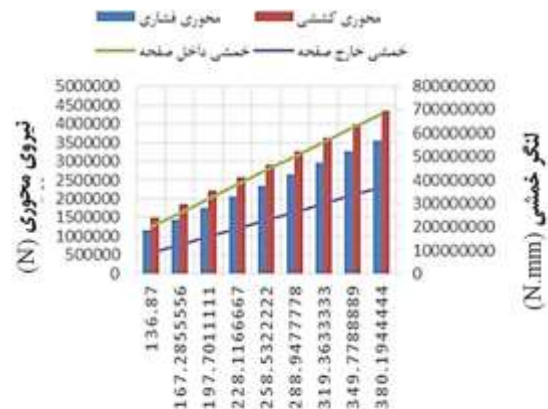
شکل (۶) تغییر مقدار تابع حالت حدی به ازای تغییر تنش تسلیم عضو اصلی.
