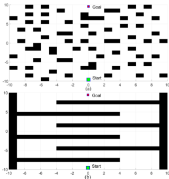
شکل (۷) a-فضای پیکربندی بهم‌ریخته Cluttered Configuration Space (CCS). b-گذرگاه‌های باریک Narrow Passages Configuration Space (NPCS).
