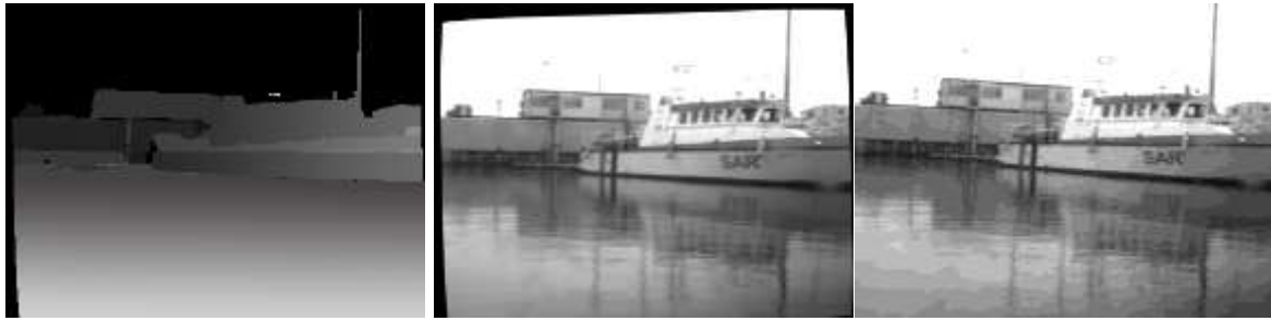
الف) تصویر اولیه گرفته شده از محیط (ب) تصویر یکسو (رکتیفای) شده (پ) نقشه تمایز متناظر
