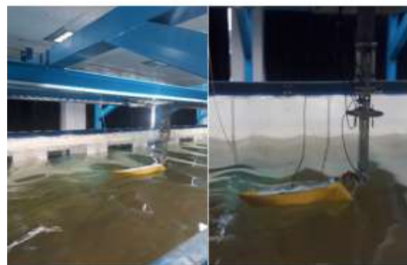
شکل (۷) آزمایش مربوط به شتاب مرکز ثقل برای سرعت ۰/۶.
