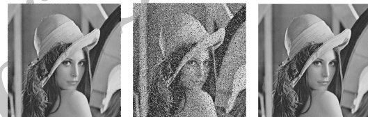
شکل ۲: الف. تصویر اصلی، ب. تصویر با چگالی نویز ضربه‌ای ۲۰٪، ج. تصویر بهبودیافته با فیلتر پیشنهادی
