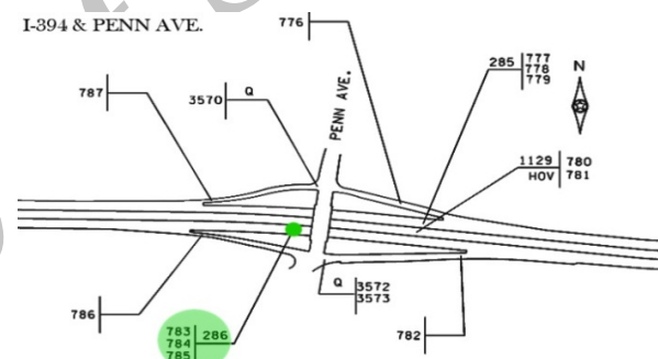
شکل ۹: دریافت‌کننده‌های حلقه‌های d783، d784، d785 نصب‌شده در ایستگاه شماره ۲۸۶ بزرگراه I-394 (مسیر غرب به شرق) [۳۷]
