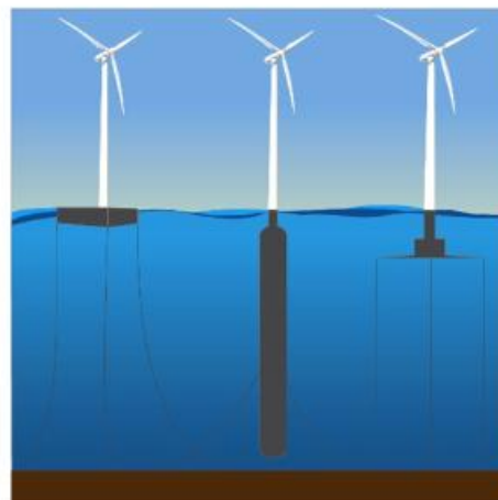
شکل ۱: روش نصب انواع توربین‌های بادی شناور فراساحلی. سکوی پایه کششی (راست)، دکل شناور پایدار شده با شن و ماسه (وسط)، سکوی شناور بر روی سطح دریا (چپ)
