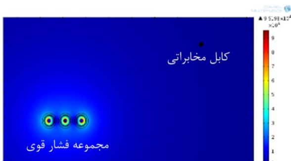
شکل ۴- خروجی نرم افزار برای میدان مغناطیسی (A/m) در حالت اول هر دو کابل بدون پوشش الکترومغناطیسی
