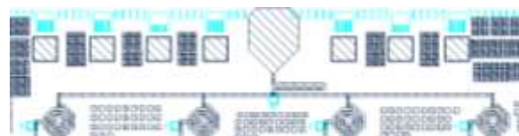
شکل ۲۱: جانمایی تقسیم/ترکیب‌کننده ویلکینسون فشرده طراحی شده
