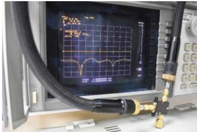
شکل ۱۱: افت بازگشتی دهانه‌ی ورودی تقسیم‌کننده‌ی توان ساخته‌شده هنگام اتصال به تحلیل‌گر شبکه (هر خانه معادل ۱۰dB است).
