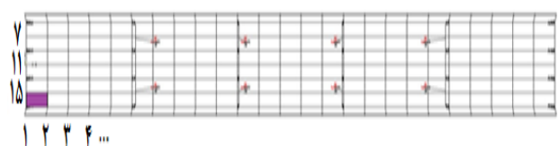
شکل ۶. ایجاد آسیب در پل پنج‌دهانه در المان بین مقاطع عرضی ۱ و ۲ روی مقطع طولی ۱۵
