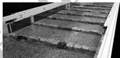
شکل (۶) نمای مدل فیزیکی از پایین‌دست با دبی سه لیتر بر ثانیه [۸]
