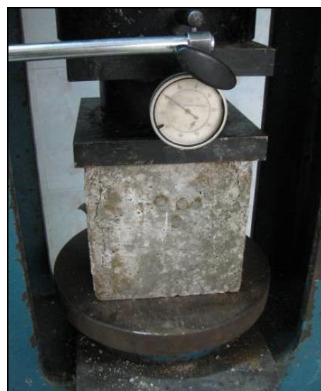
شکل (۱۵) انجام آزمایش مقاومت تک محوری بتن
