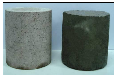
شکل (۸) نمونه آندزیت بعد از آزمایش
