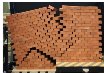
شکل (۱۱) مقایسه سازوکار خرابی دیوار تحت نشست تکیه‌گاهی در مدل عددی و آزمایشگاهی
