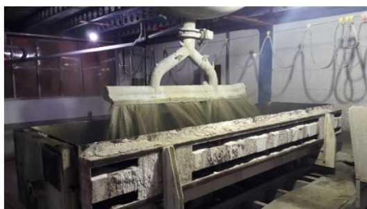
الف) ریختن دوغاب بلوک از سیلو به داخل قالب
