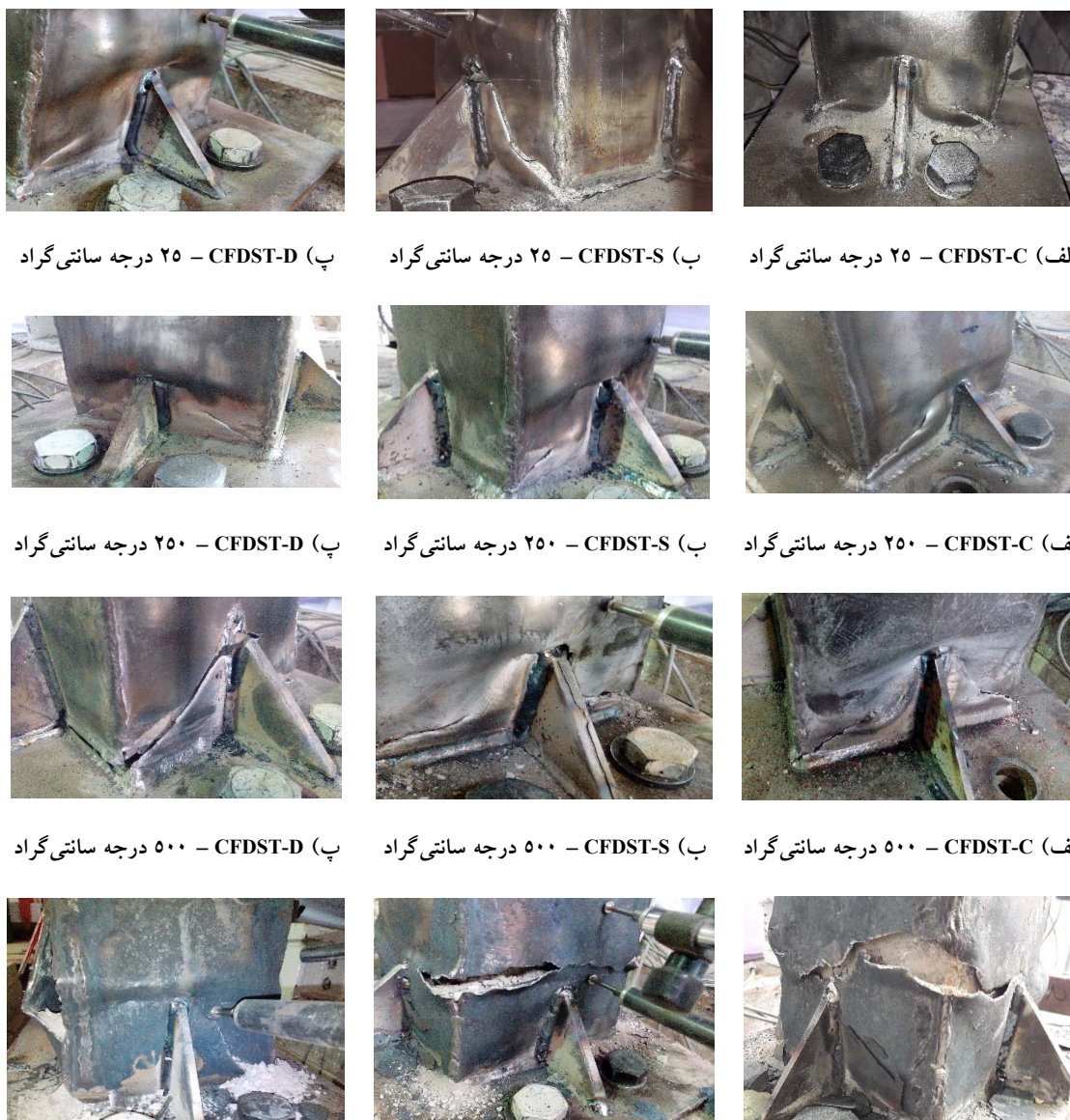
شکل ۱۰: مود گسیختگی ستون ها در دماهای مختلف
