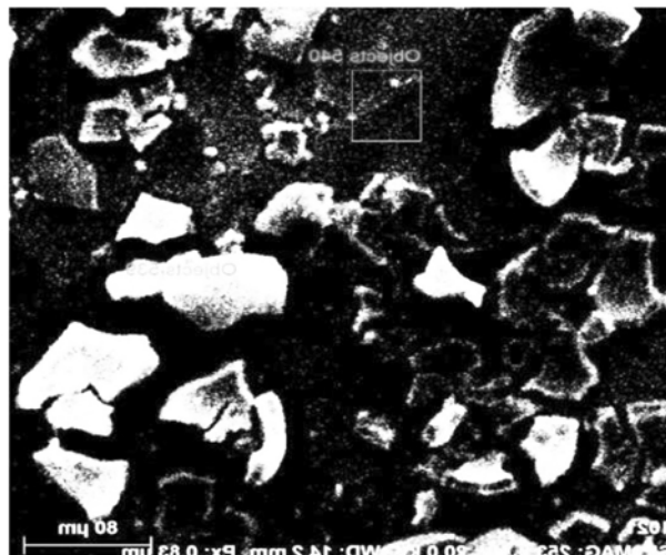
شکل ۲- مورفولوژی پوشش تبدیلی تشکیل شده در الف (۱۰ دقیقه ب) ۳۰ دقیقه ج) ۶۰ دقیقه و د) ۱۲۰ دقیقه غوطه‌وری در محلول اشباع \text{NaHCO}_3 .
