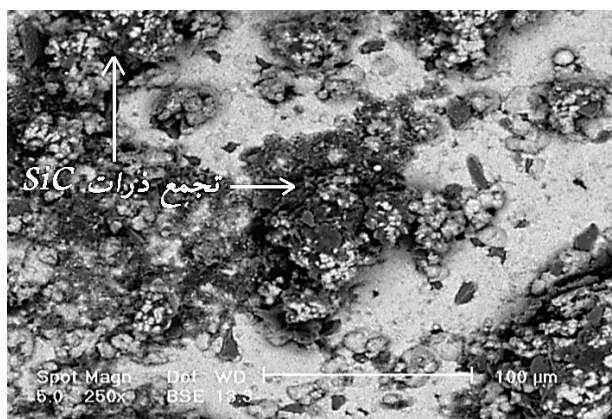
شکل ۸ - تصویر SEM از مورفولوژی سطح پوشش ۱۵ گرم SiC و تجمع ذرات SiC در قسمت برآمدگی.
