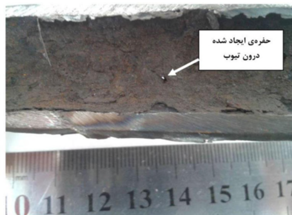
شکل ۲- تصویر سطح داخلی تیوب A، پوشیده شده با رسوب سیاه‌رنگ و ضخیم، یک حفره درون تیوب مشاهده می‌گردد.
