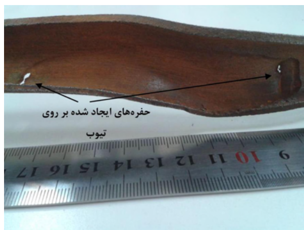
شکل ۹ - تصویر سطح داخلی تیوب C که در اثر کاهش ضخامت ناشی از خوردگی موضعی سوراخ شده است.
