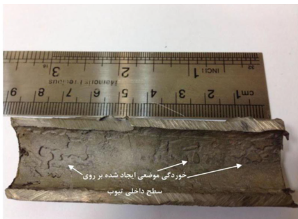
شکل ۳- تصویر سطح داخلی تیوب A بعد از فرایند اسیدشویی. وجود خوردگی موضعی شدید بر روی سطح داخلی تیوب مشاهده می‌گردد.
