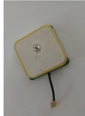
شکل (۲): آنتن Patch مربوط به GPS رادیوسوند
