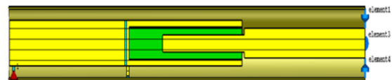
شکل (۲۲): ساختار دوقطبی‌کننده بلوملین با بهره بردن از کلید جرقه‌زن صفحه- صفحه.
