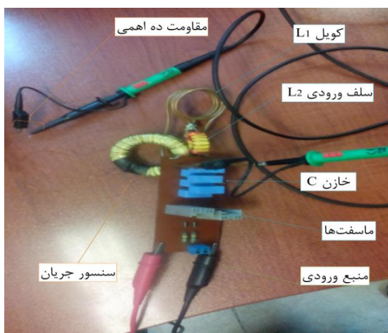
شکل (۲۲): گرم‌کن القایی به همراه حسگر جریان.
