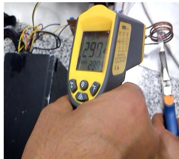
شکل (۲۰): دمای فلز درون گرم‌کن.
