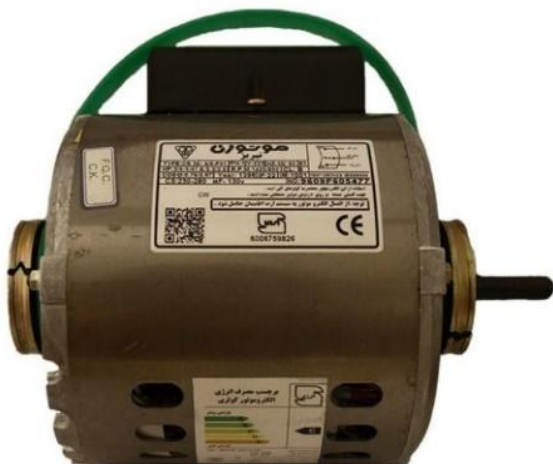
شکل (۲): موتور القایی تک‌فاز خازن راه‌انداز
