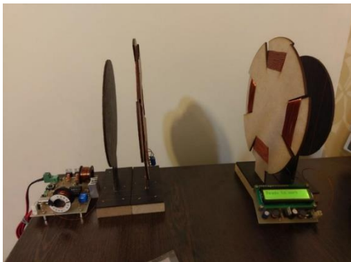
شکل (۴): پیاده‌سازی سامانه انتقال توان بیسیم
